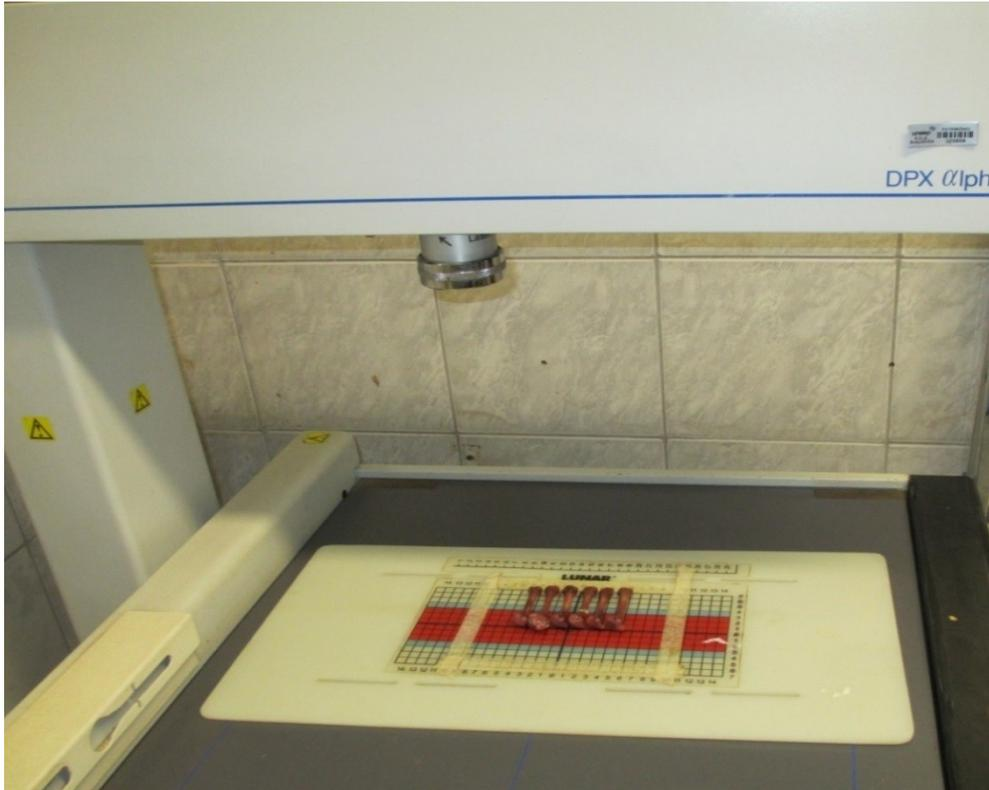
FIGURA 3. Densitômetro modelo DPX-ALPHA.
