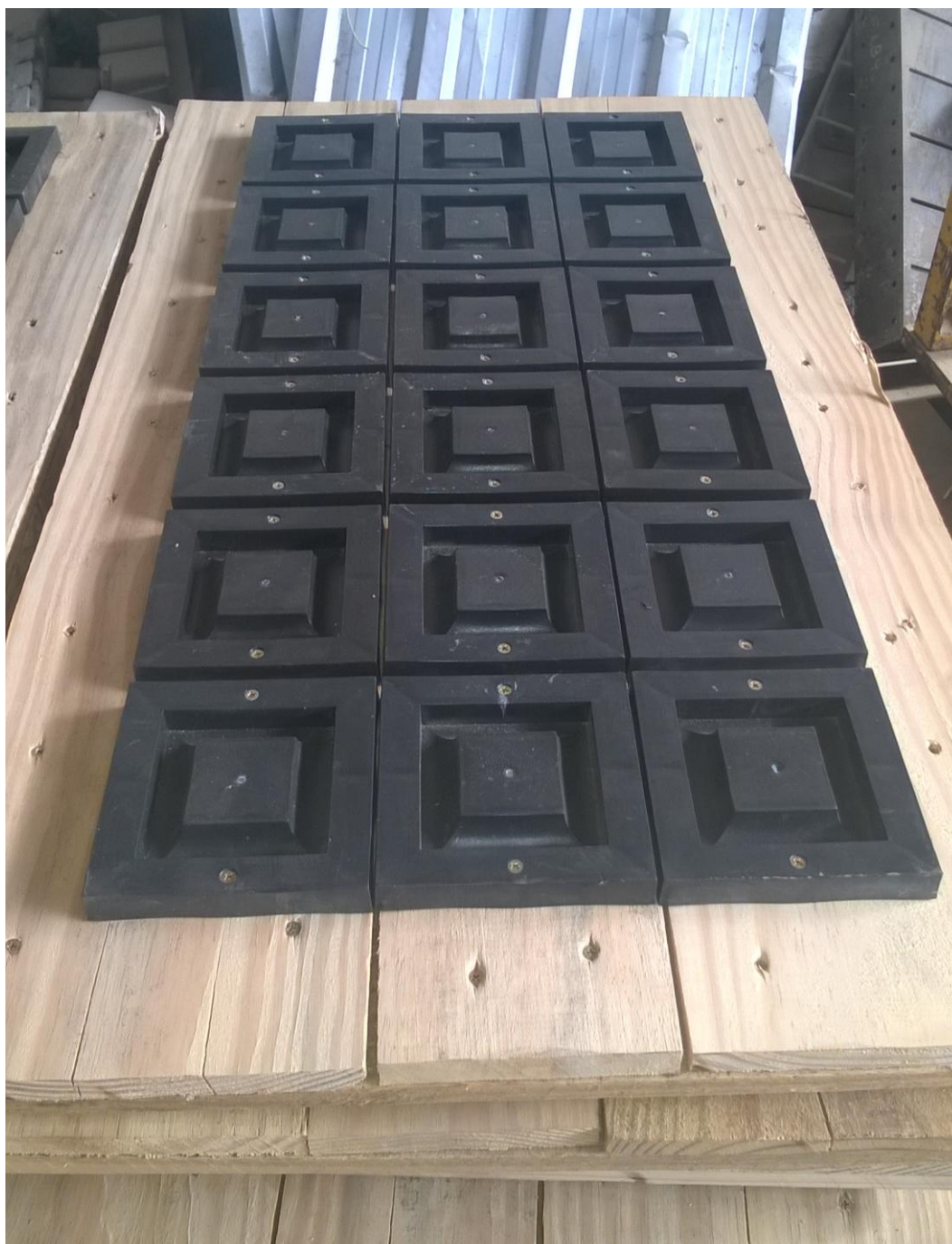
Figura 04 – Fôrmas instaladas em peças de madeira para confecção das saliências do bloco SOMONTAR
