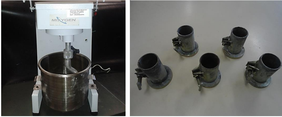
Figura 4.8 – Equipamentos utilizados para produção dos compostos cimentícios: a argamassadeira e b moldes.
