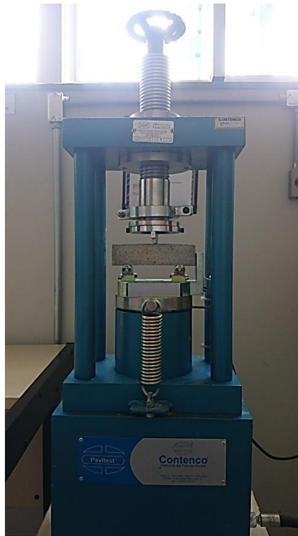
Figura 4.10 – Execução do ensaio de tração na flexão
