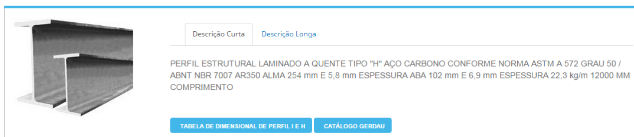
Figura 56 – Especificação de um Perfil “H” 10” em Aço Estrutural Laminado - disponível na ferramenta MEX na internet.
