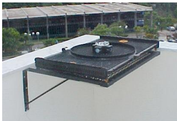
FIGURA 62 Base para o sensor de medição da iluminância global e a cruzeta.
