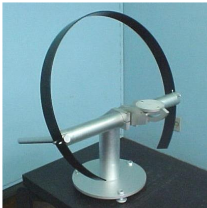
FIGURA 60 Base para sensor de iluminação difusa: sensor com o anel de sombreamento.
