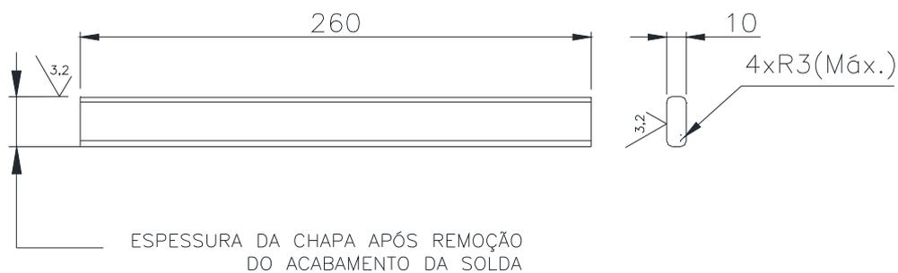
Figura 18 - Corpo de prova de dobramento.
