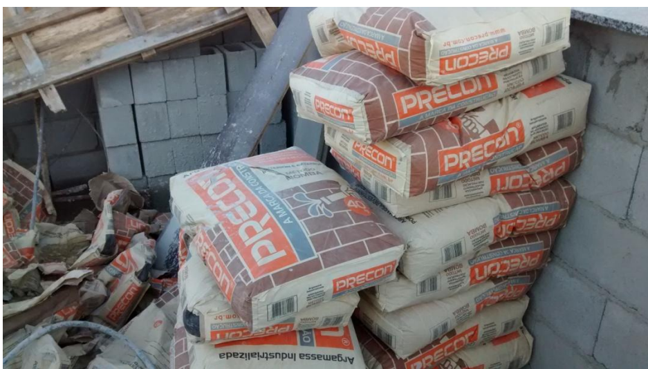
Figura 02 – Saco de 40 kg de argamassa projetada da Precon
