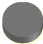
Figura 23: Forma dos corpos-de-prova obtidos para análise de VHN. Com 3 mm de diâmetro e 2 mm de espessura.
