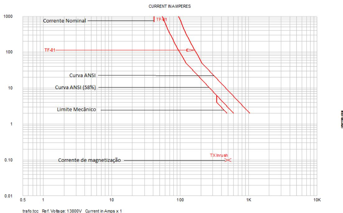
Figura 3.3- curva de suportabilidade contra curto-circuito de um transformador categoria II com conexão delta estrela (delta do lado primário).
