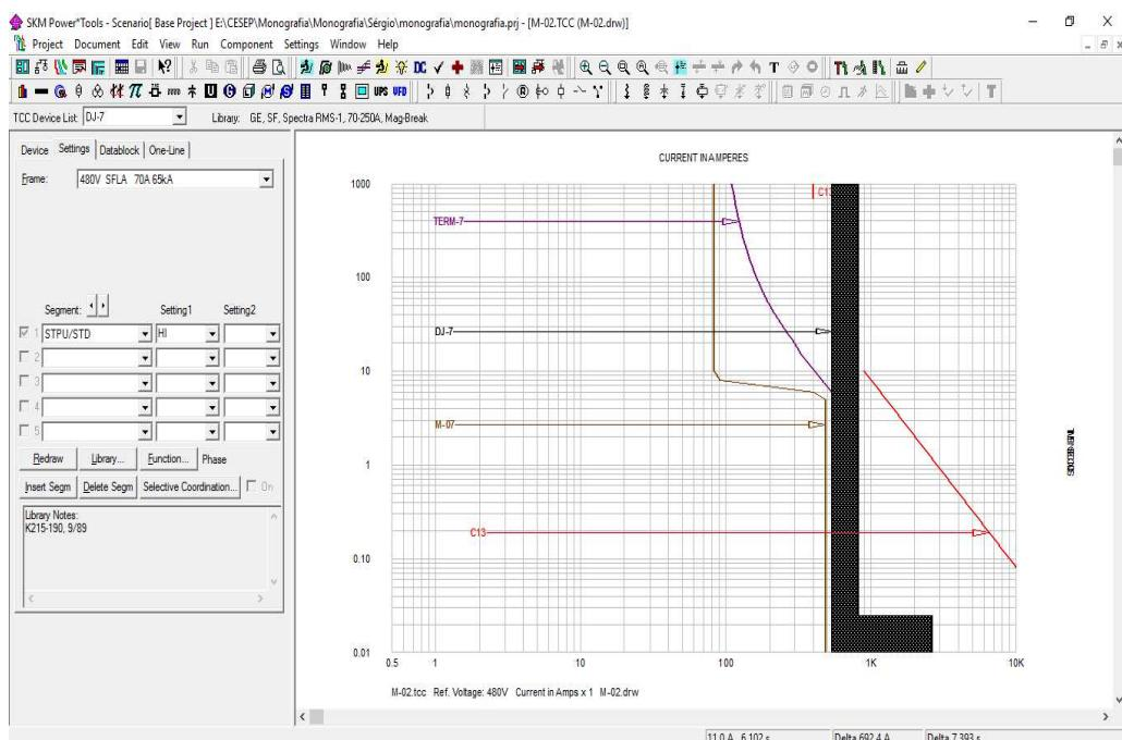
Figura 4.5 – Time Current Curve (TCC) do transformador TF-02 e suas proteções.
