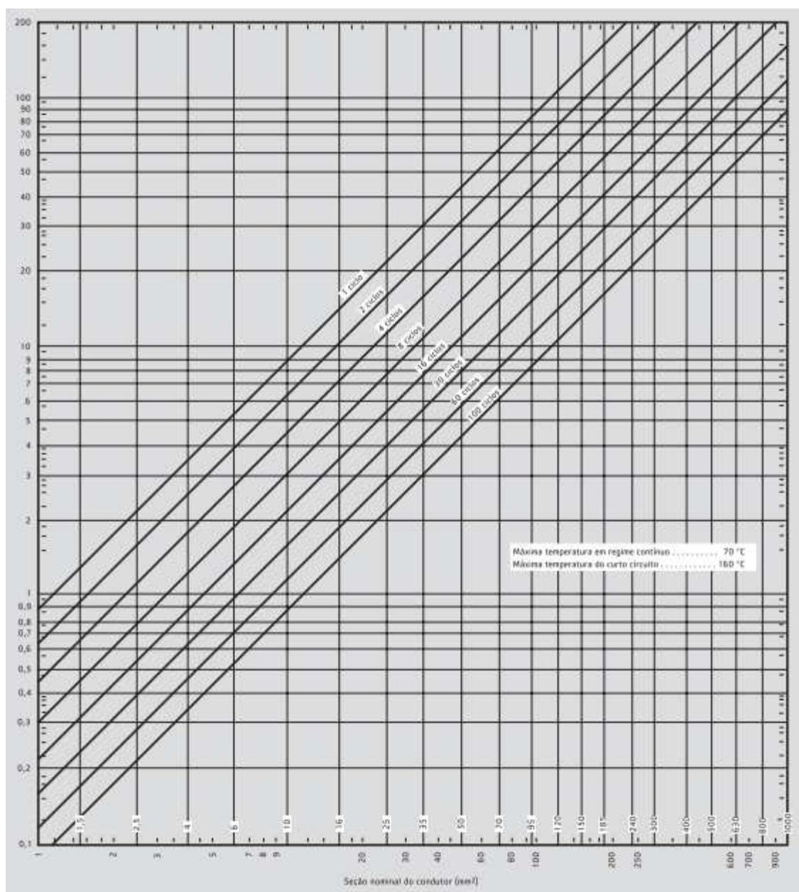
Figura 3.1- curva de corrente de curto-círcuito x diâmetro do condutor.
