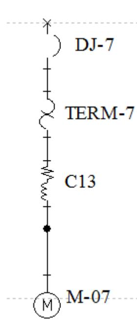
Figura 4.8 - Diagrama unifilar para motor de 37 kW baixa tensão.
