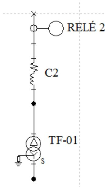
Figura 4.14 - Diagrama unifilar para transformador 13,8-0,48 kV.
