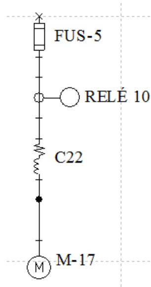
Figura 4.12 - Diagrama unifilar para motor de 370 kW média tensão.
