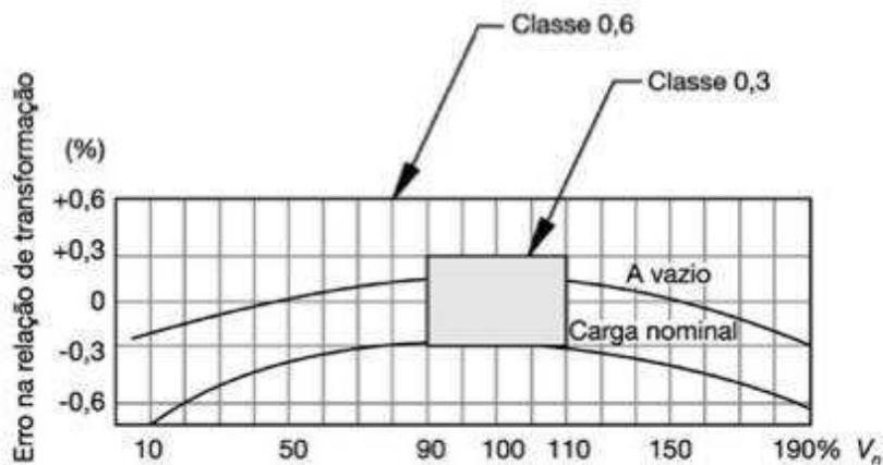
Figura 2.2- Curva de ensaio de exatidão: erro de relação de transformação<sup>4</sup>.
