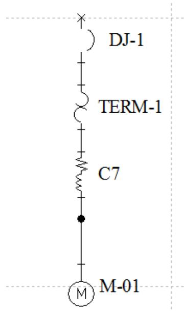
Figura 4.6 - Diagrama unifilar para motor de 55 kW baixa tensão.
