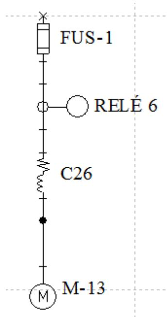
Figura 4.10 - Diagrama unifilar para motor de 200 kW média tensão.
