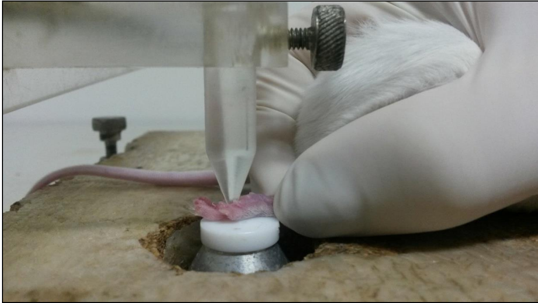
Figura 12 - Parte compressora do aparelho (Ugo Basile, Itália) utilizado para medir o limiar de resposta ao estímulo mecânico aplicado na pata de camundongos.
