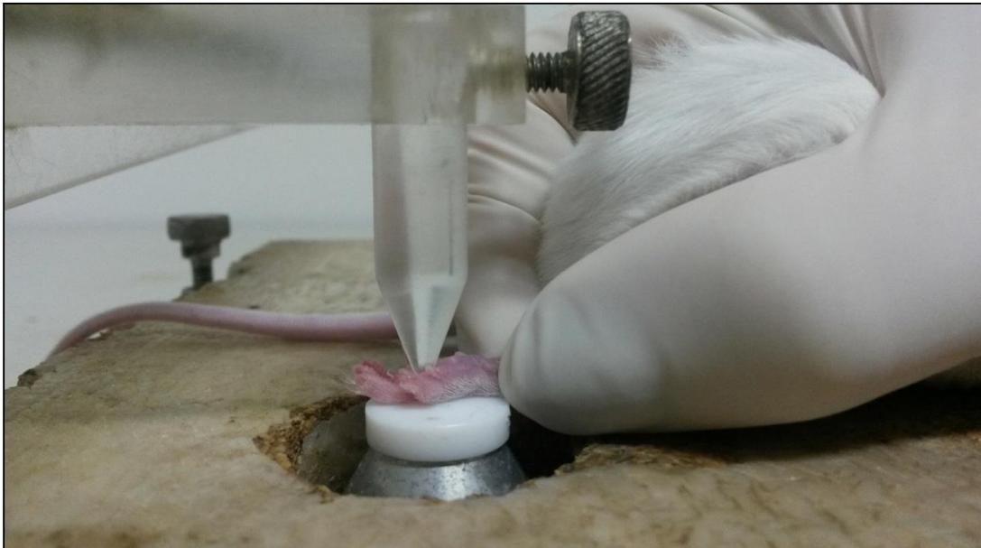
**Figura 16 - Parte compressora do aparelho (Ugo Basile, Itália) utilizado para medir o limiar de resposta ao estímulo mecânico aplicado na pata de camundongos.**
