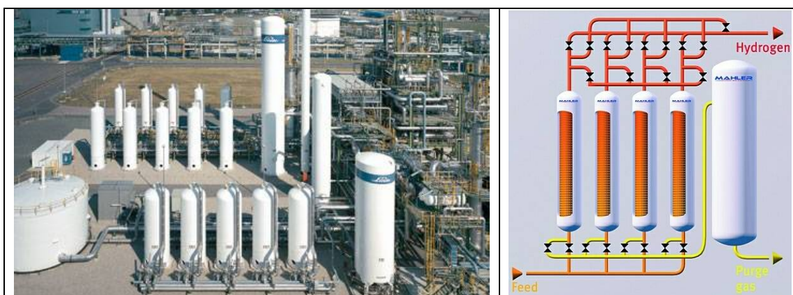
Figura 3.9 – Exemplos de uma planta real e desenho esquemático da conexão entre os equipamentos de unidades típicas de PSA. Fontes: Linde 8 e Mahler-ags 9
