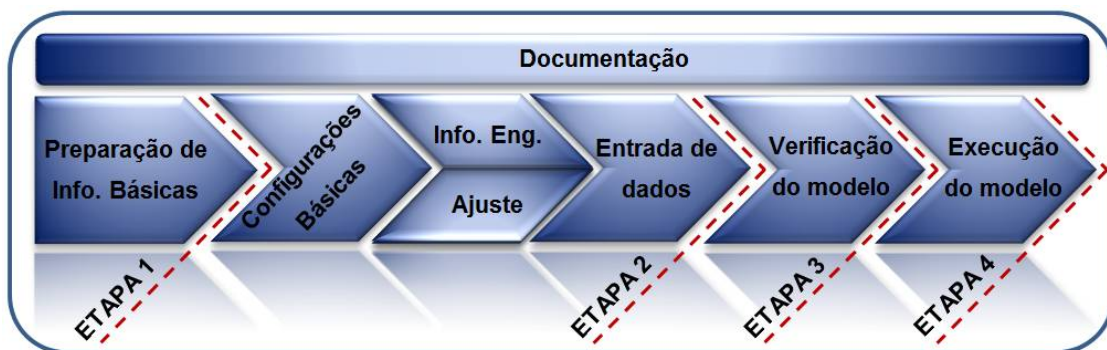
Figura 7.1 – Etapas para a elaboração de modelos dinâmicos de processos
