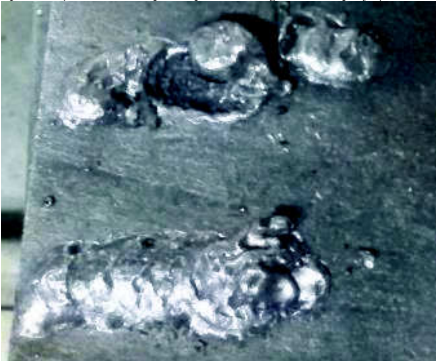
Figura 33 - Cordões de Solda obtidos para Soldagem com Eletrodo Revestido com Óleo de Soja Epoxidado (sem adição de feldspato de potássio – fotografia sem ampliação).
