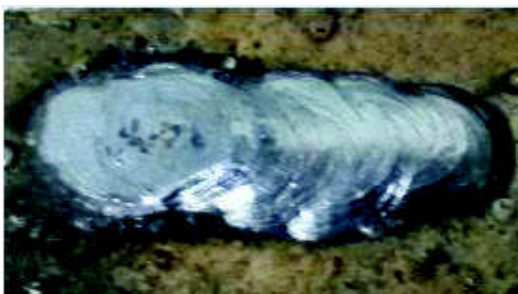
Figura 31 - Fotografia de cordão de solda produzido com eletrodo revestido convencional E6013 (sem ampliação).
