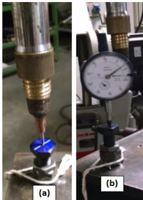
FIGURA 3.8 - Calibração do relógio comparador como ferramenta de trabalho do robô.
