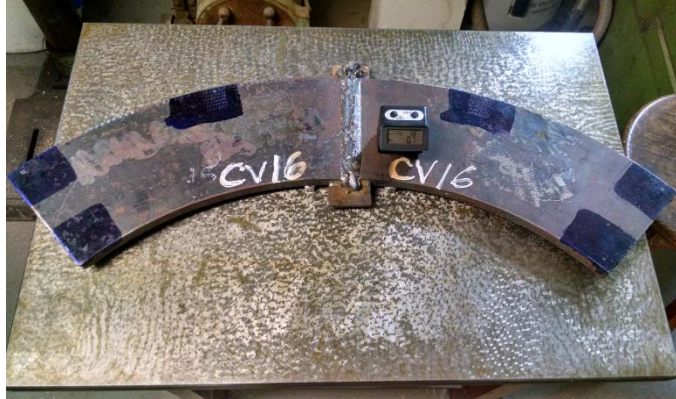
FIGURA 7.10 – Medição do corpo de prova sobre a mesa de desempenho.
