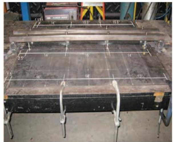
c) Sistema de fixação dos corpos de prova para soldagem
