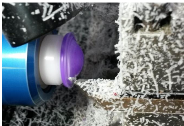
Figura 43: Torneamento da curva anterior
