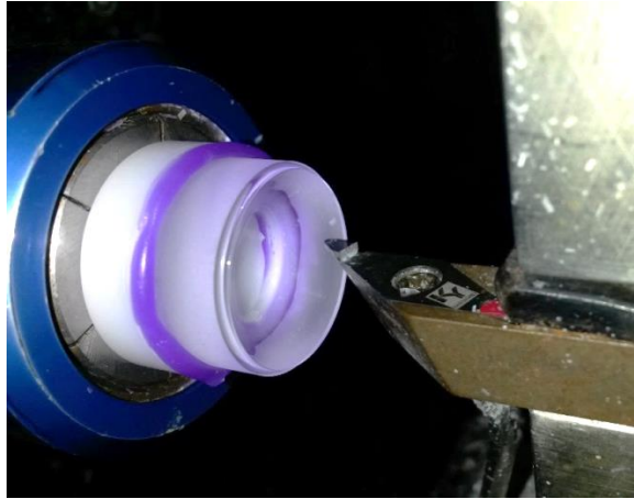
Figura 41: Torneamento da curva base
