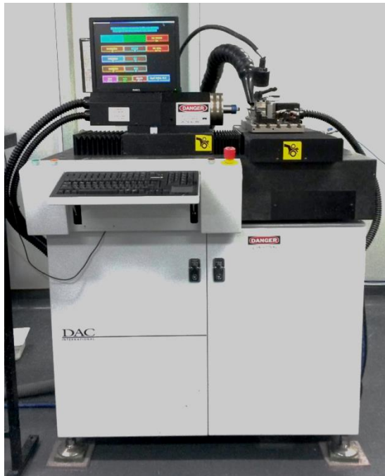
Figura 38: Torno CNC para produção de lentes de contato.
