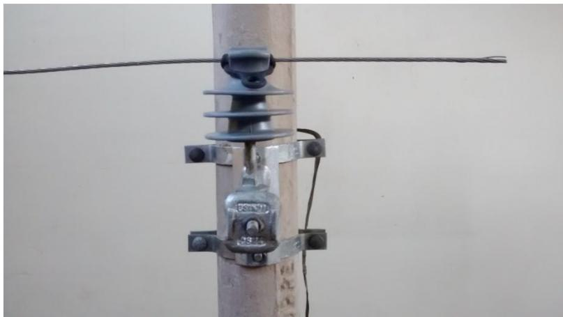
Figura 5.1 Estrutura CM2 ensaiada utilizando-se cabo nu.
