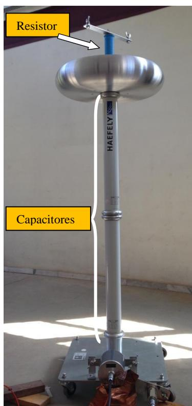
Figura 4.10 Divisor de tensão capacitivo
