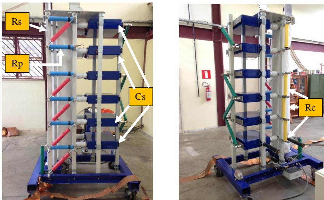
Figura 4.6 Gerador de tensão impulsiva tipo Marx. Modelo SGS-600/30.
