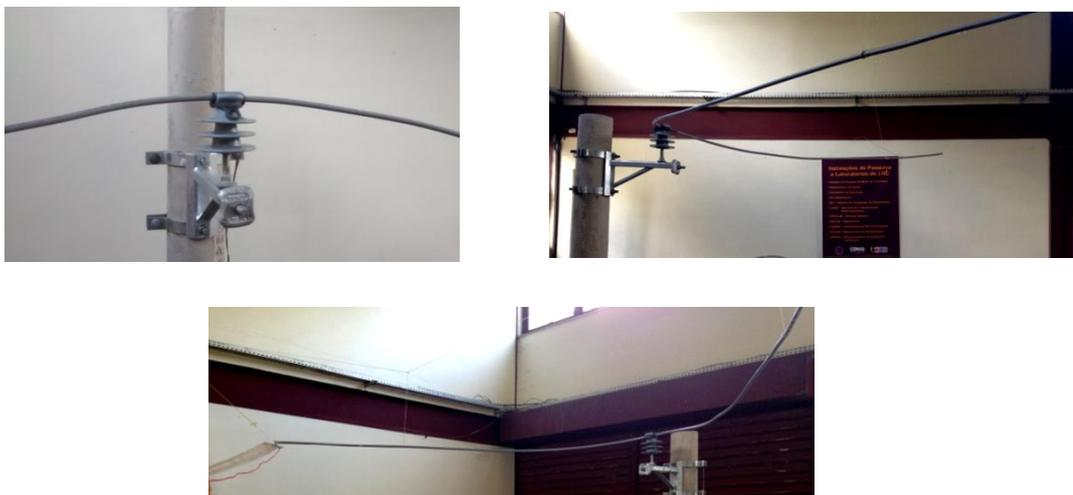
Figura 4.25 Estrutura CM2 ensaiada na presença do cabo coberto.
