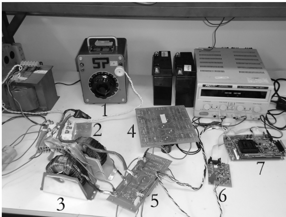
Figura 5.14. Bancada de testes experimentais : Varivolt (1), Ponte de diodos (2), Indutor (3), Associação de Capacitores (4), Placa contendo o IGBT (5), Driver (6) e DSP 2812 da Texas (7).
