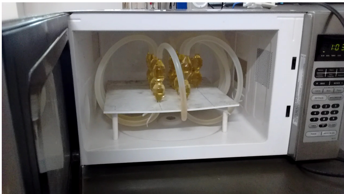
Figura 4-3: Sistema com módulos de vidro apoiados no suporte de teflon e conectados por mangueiras de silicone
