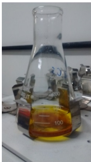
Figura 4-16: Biodiesel com resina de troca iônica na mesa agitadora
