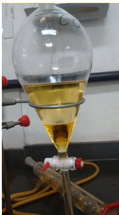
Figura 4-15: Produtos da reação no funil de separação após 24 horas de decantação
