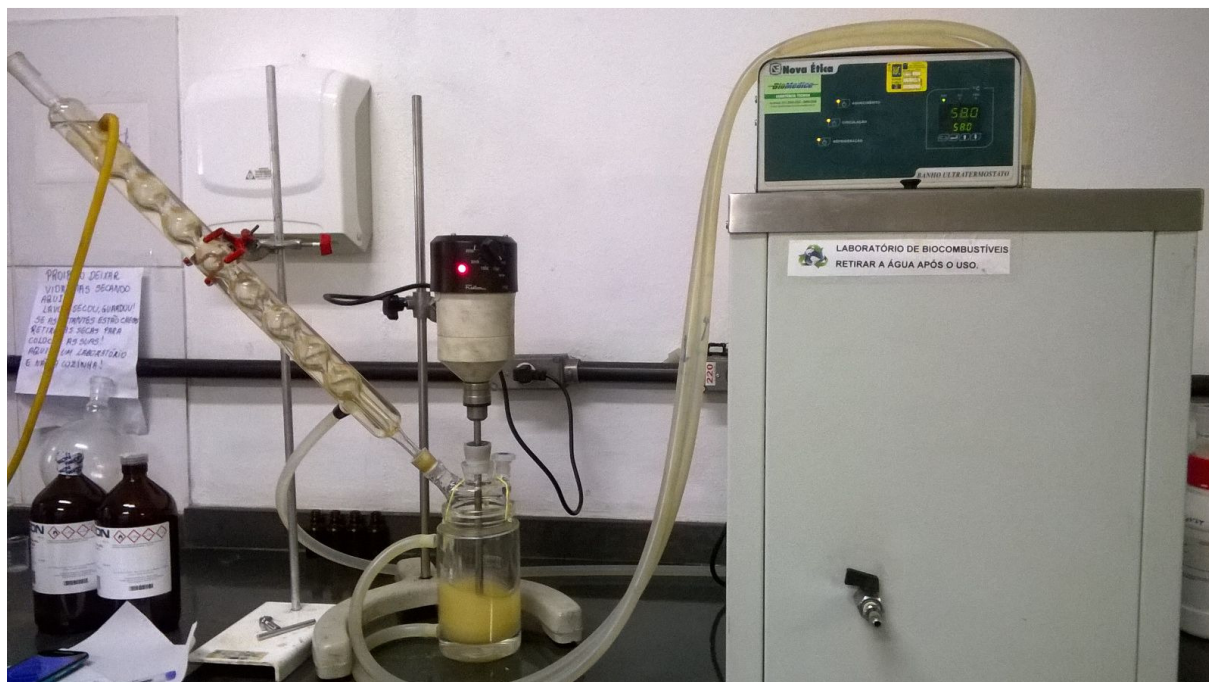
Figura 4-13: Fotografia da montagem do reator batelada com aquecimento convencional
