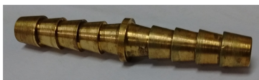
Figura 4-7: Peça de latão do tipo entrada de mangueira nas duas extremidades
