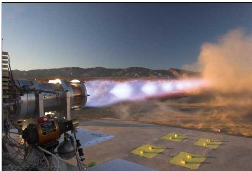
FIGURA 2.16 - Foto de um motor foguete a Gás Natural em teste no deserto norte-americano. FONTE: BARRY, 2007
