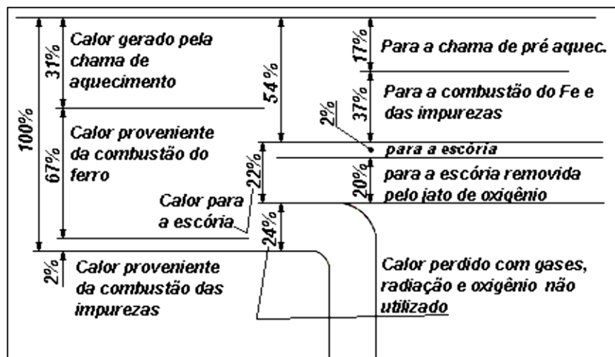
FIGURA 2.12 - Distribuição de calor no corte de uma chapa de 15 mm em forma diagramática.
