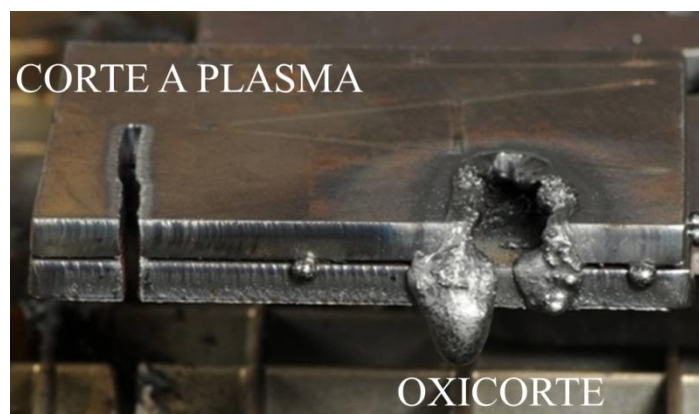
FIGURA 2.9 - Comparativo corte de chapas empilhadas, corte a plasma (esq.) e oxicorte (dir.). FONTE: BRINE, 2015.
