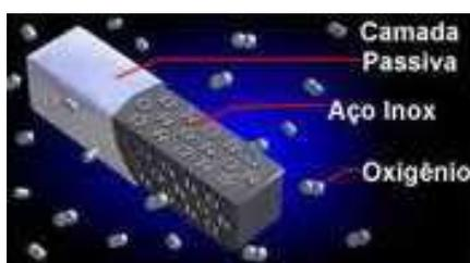
**Figura 16** – Ilustração da camada passiva dos aços inoxidáveis.
