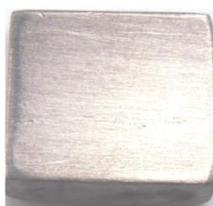
**Figura 25** – Amostra de aço inoxidável logo após sua preparação para imersão.
