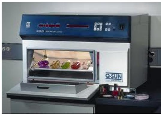
Figura 3.19: Câmara de Intemperismo- marca Q-Sun XE-1.
