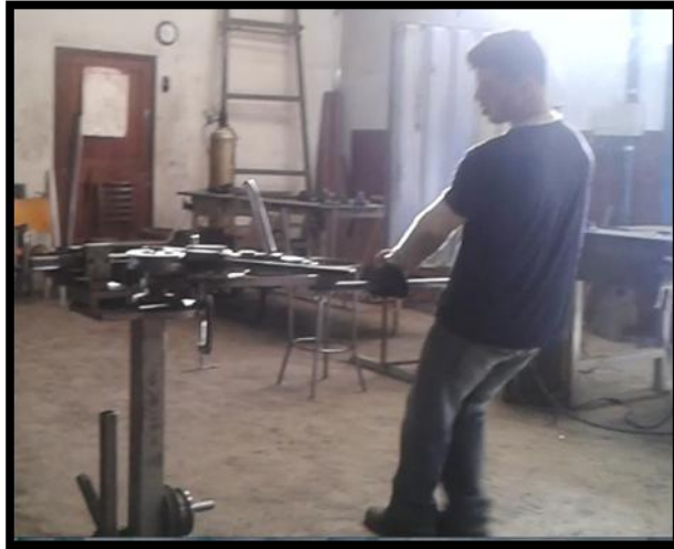
FIGURA 2- Trabalhador realizando a dobra do tubo metálico.
