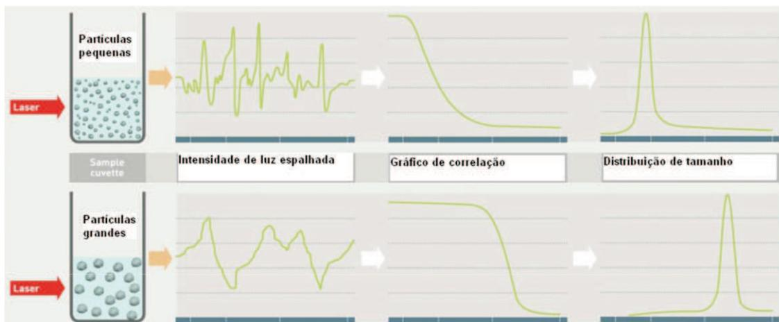
**Figura 16** - Princípio geral de funcionamento do DLS e equação de Stokes-Einstein. Fonte: GRASSIAN RESEARCH GROUP AT THE UNIVERSITY OF IOWA DEPARTMENT OF CHEMISTRY, 2014; MALVERN INSTRUMENTS LTD., 2015a.
