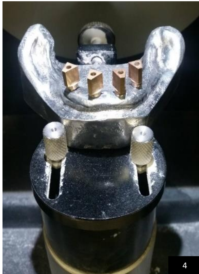
FIG. 4: Posicionamento do modelo mestre sobre a plataforma do scanner S600 ARTI.
