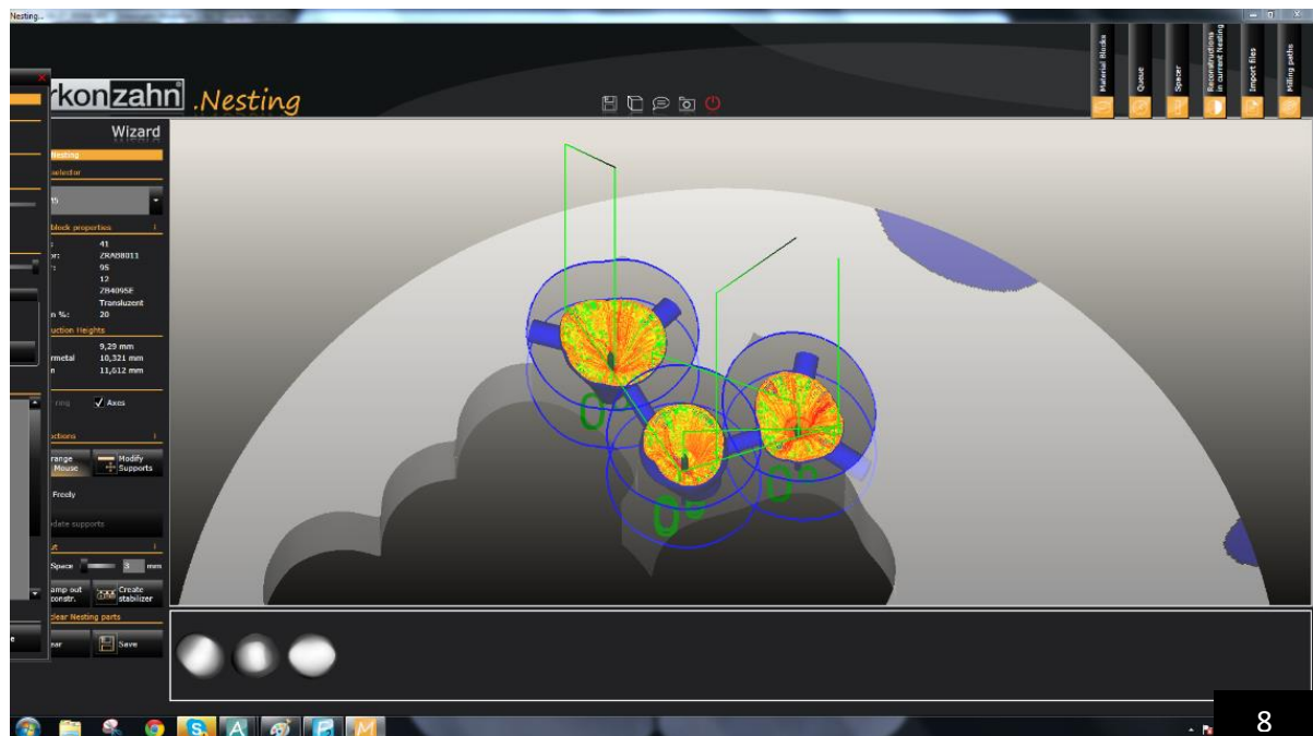
FIG. 8: Definição da inclinação das fresas e das rotas de fresagem.
