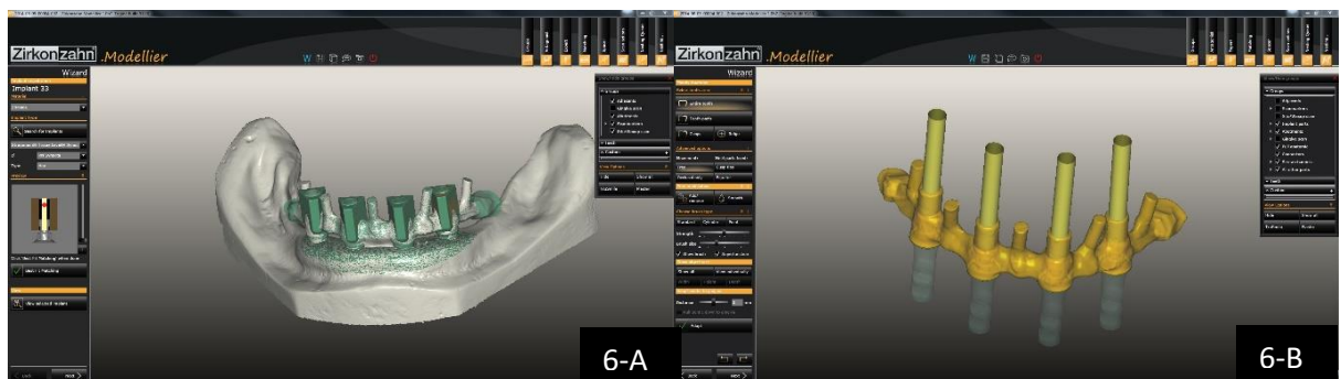
FIG. 6-A: Posicionamento virtual dos implantes ao modelo mestre e aos scan abutments por meio do software .Modellier .
