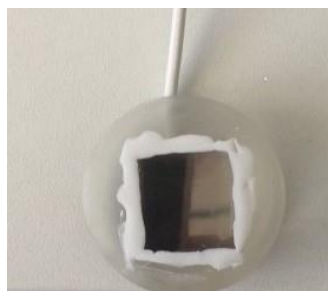
Figura 27- Amostra do aço inoxidável AISI 904L devidamente preparada para posteriores testes eletroquímicos
