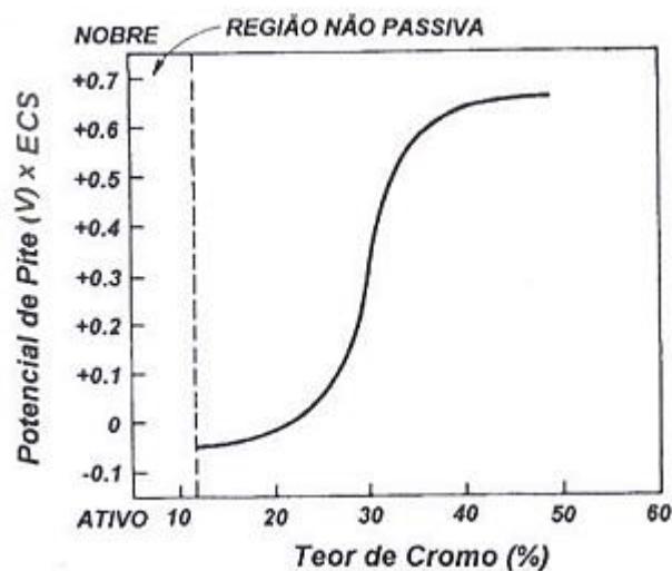
Figura 14- Efeito da quantidade de Cr no potencial de pite ( E_p ) de liga Fe-Cr em solução desaeerada 0,1 N NaCl a 25% (BOTTON, 2008).
