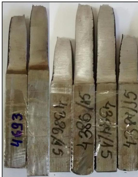
FIGURA 4.1. Corpos de prova após rompimento no ensaio de tração.
