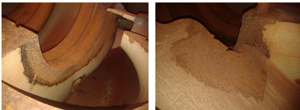
FIGURA 2.3. Desgaste por erosão ocorrida em uma carcaça de uma bomba de água.
