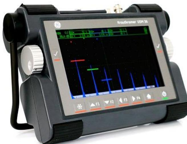
FIGURA 3.4. Aparelho portátil de Ultrassom GE Kroutkromer USM 36.
