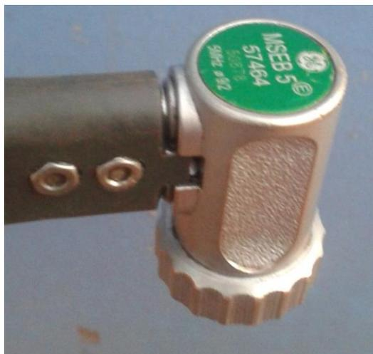
FIGURA 3.5. Cabeçote GE MSEB 5 de 5 Mhz e diâmetro 9/2 mm de duplo cristal.
