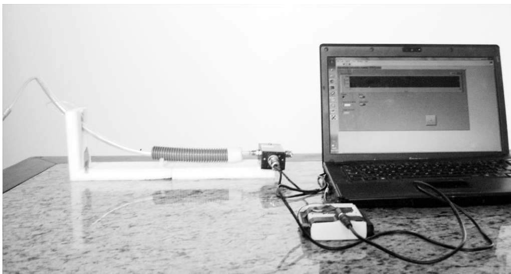
Figura 6 Sistema de teste para avaliação das pressões negativas nas diferentes pressões de vácuo e em diferentes diâmetros de cateter de aspiração endotraqueal
