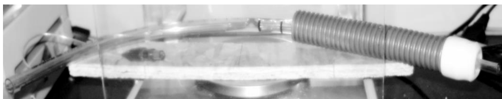
Figura 7 Pesagem do conjunto cano corrugado e tubo endotraqueal, uso de suporte de madeira para permitir a pesagem
