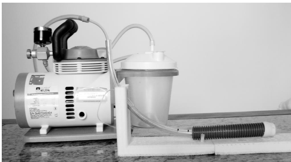
Figura 8 Sistema para a simulação da aspiração endotraqueal
