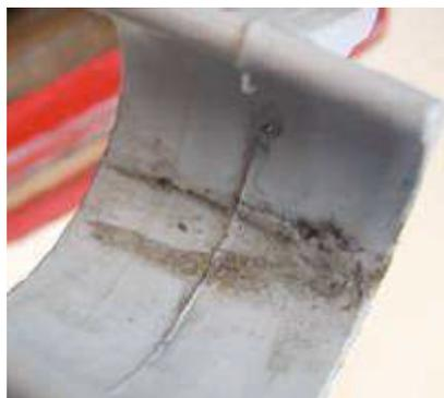
Figura 14: Fotografia de parte do espaçador losangular que sofreu a ação do trilhamento elétrico em sua superfície [Hartmann, 2008].
