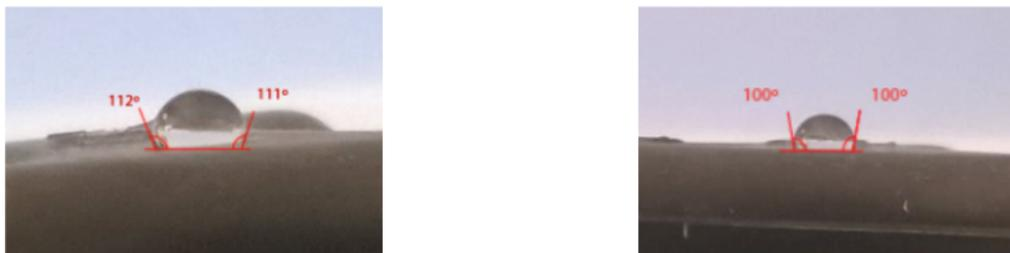
Figura 49A: Fotografias do teste de hidrofobicidade para a amostra AED após 71 dias que foi retirada do estresse.
