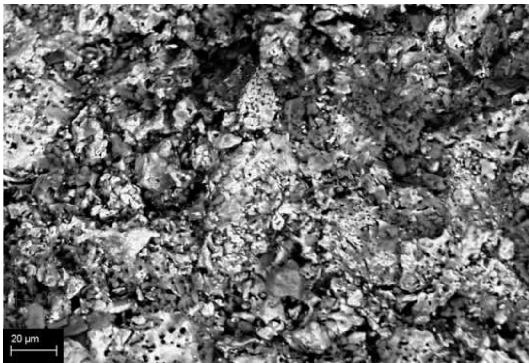
Figura 5.9 – Morfologia do ferro metálico via MEV da pelota P1 reduzida na temperatura de 850 °C.
