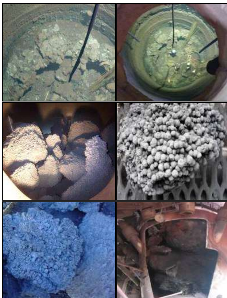
Figura 3.11 – Fotos de manutenção de reatores RD após problemas de cachos (ALENCAR, 2014a).
