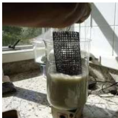
Figura 4.2 – Foto da técnica de imersão para aplicação de recobrimento nas pelotas.
