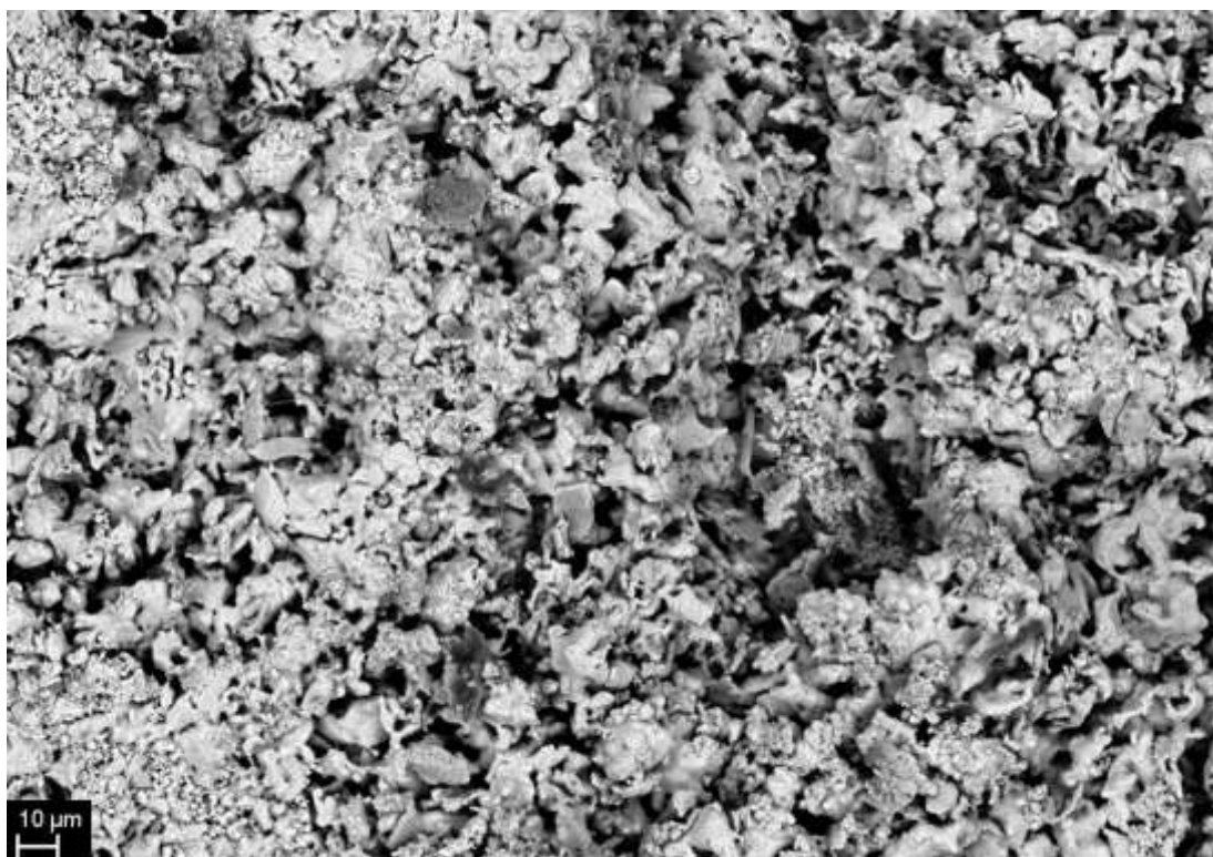
Figura 5.14 – Morfologia do ferro metálico via MEV da pelota P3 reduzida na temperatura de 950 °C.
