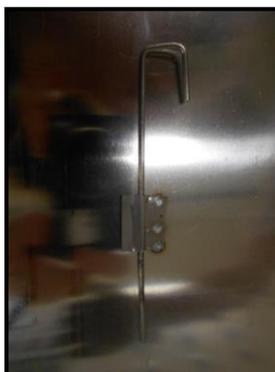
Figura 4.2: Amostra com termopar acoplado.
