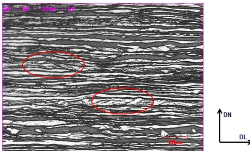
Figura 5.11: Micrografia da região central da bobina laminada a frio com redução de 62% do AID S32304: Bandas de cisalhamento (círculo vermelho). Ataque Behara.
