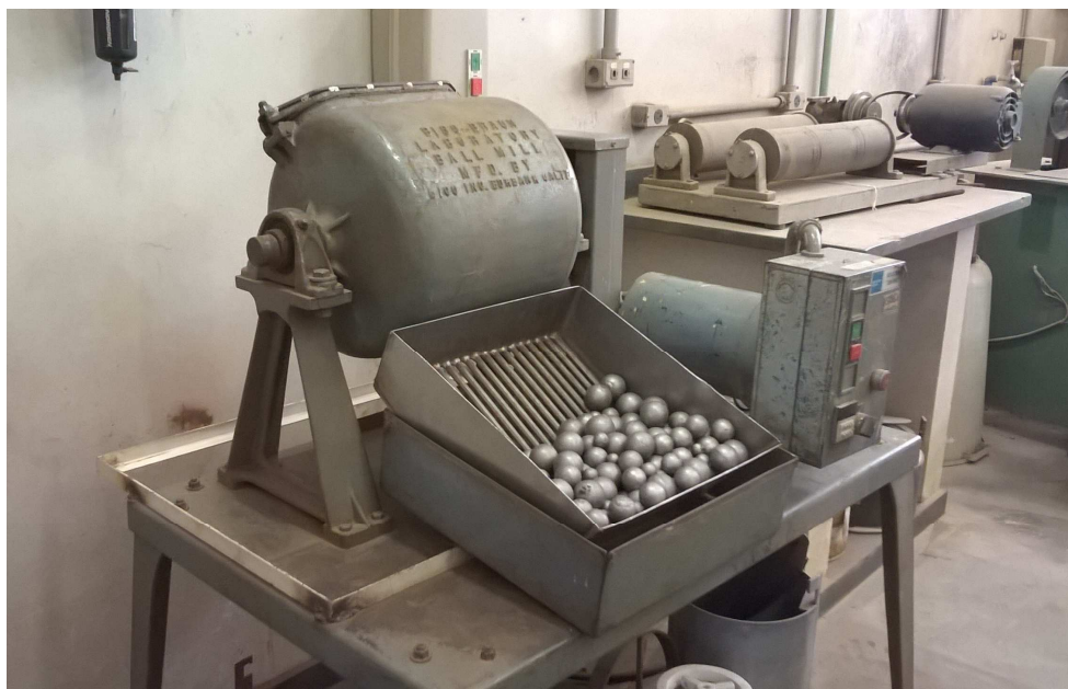
Figura 3.3 - Moinho de Bond e carga de bolas padrão do teste. Laboratório de Tratamento de Minérios. Departamento de Engenharia de Minas UFMG.
