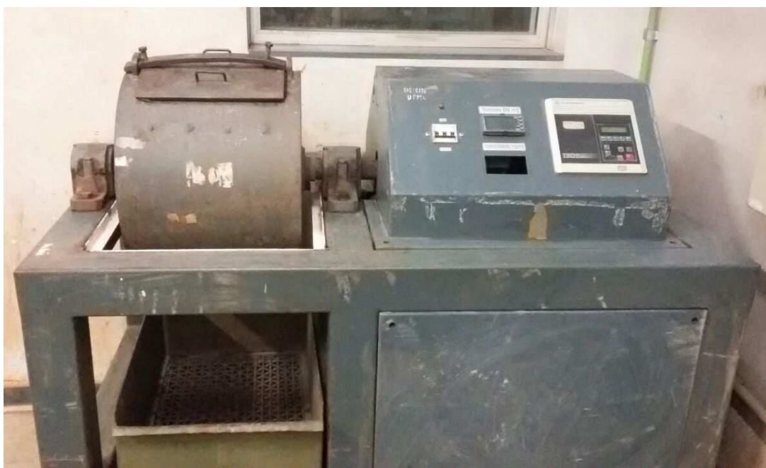
Figura 4.5 - Moinho de laboratório com sensor de torque - Laboratório de Tratamento de Minérios do Departamento de Engenharia de Minas - UFMG.
