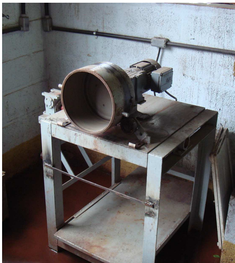
Figura 4.4 - Moinho utilizado na metodologia da Fundação Gorceix para moagem primária.
