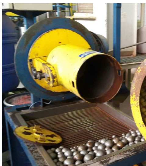
Figura 4.7 - Moinho e carga de bolas utilizados na metodologia Donda para moagem primária.
