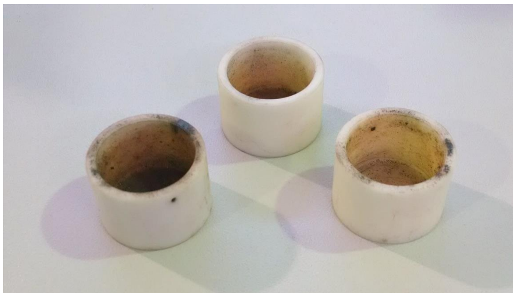
Figura 4.2 – Cadinhos utilizados no teste de volatilização.
