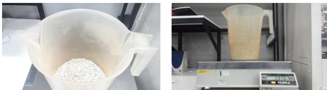
FIGURA 3.17 – Pesagem do adsorvente natural ZN 2040.
