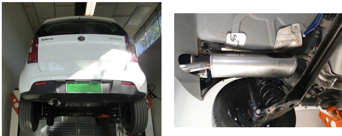
FIGURA 3.13 – Montagem do abafador de ruído com coluna de leito fixo de fluxo horizontal preenchida com adsorvente natural ZN 2040.
