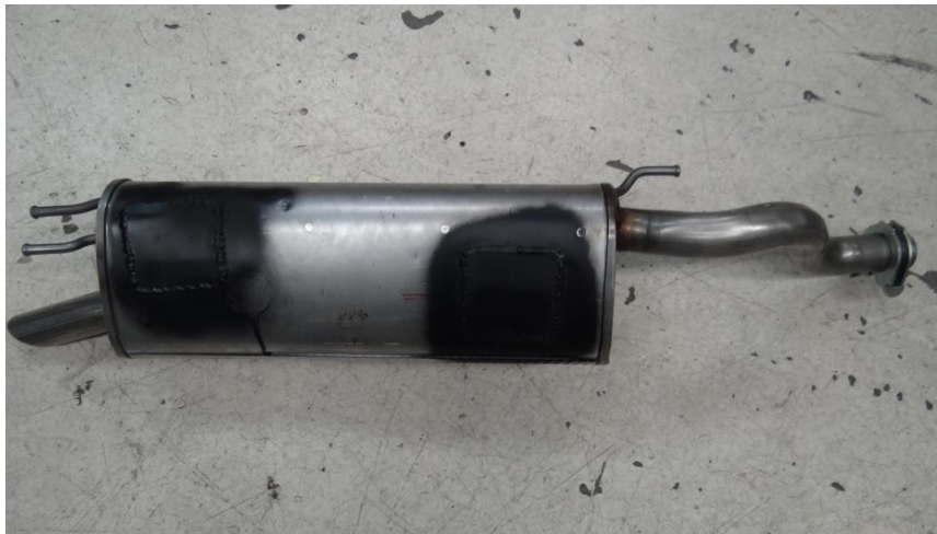
FIGURA 3.19 – Fechamento dos recortes na chapa externa do abafador de ruídos.
