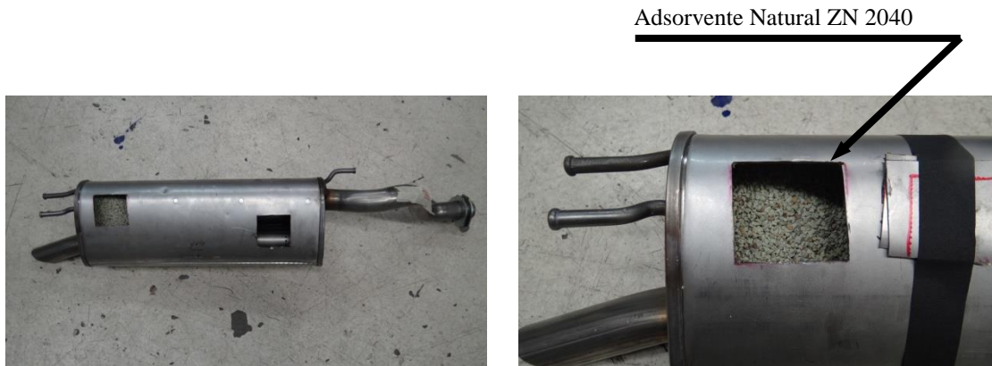
FIGURA 3.18 – Preenchimento do abafador de ruído com adsorvente natural ZN 2040.
