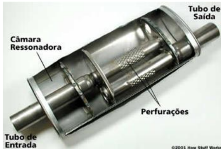
FIGURA 3.15 – Vista do interior do abafador de ruído, local de fixação dos adsorventes.
