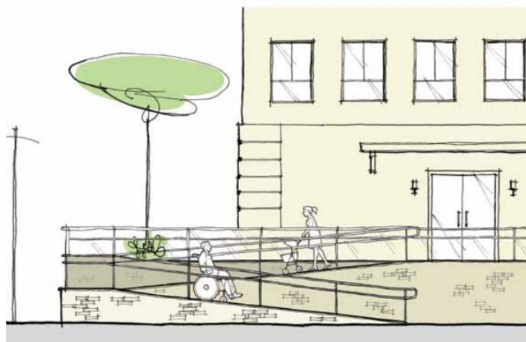
Figura 29 - Acesso seguro a um edifício através de rampas com corrimãos e guarda-corpo.
