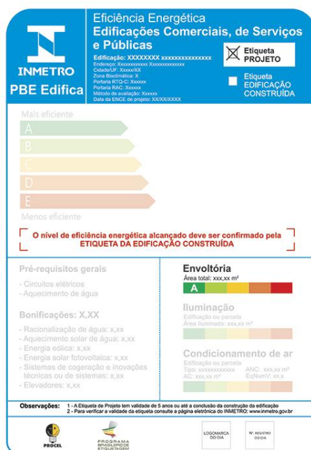
Figura 6 - ENCE parcial da envoltória. Deve ser obtida para a envoltória completa, e é obrigatória para a obtenção de qualquer outra ENCE parcial. A envoltória é composta pelas fachadas e cobertura, incluindo as aberturas envidraçadas e vãos (PROCEL, 2006).
