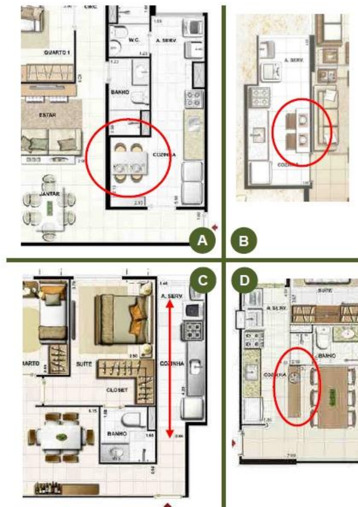
Figura 9 – A: Há local para refeições, não se sobrepondo aos espaços de outras atividades (mesa livre). B: Há local para refeições, sobrepondo-se aos espaços de outras atividades (bancada na parede). C: Não há local para refeições na cozinha. D: O local de refeições na cozinha é compartilhado com a sala (cozinha americana) (Silva et al., 2011).
