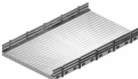
Figura 3.19 – Desenho esquemático de ponte de madeira laminada protendida.
