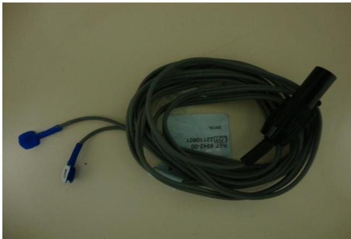
FIGURA 4: Oxímetro de pulso – sensor em “Y” para mensuração da SpO<sub>2</sub>.
