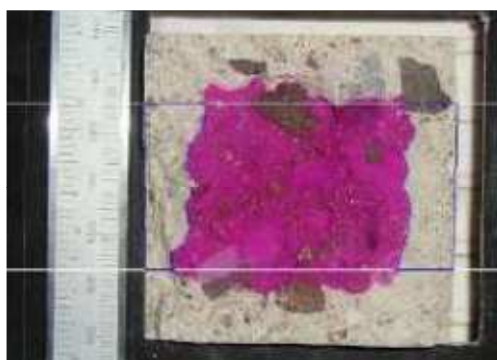
Figura 2- Corpo de prova carbonatado após aspersão da fenolftaleína.
