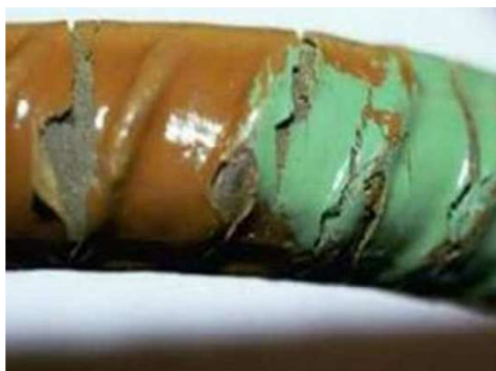
Figura 11- Falhas no revestimento devido a dobra do aço.
