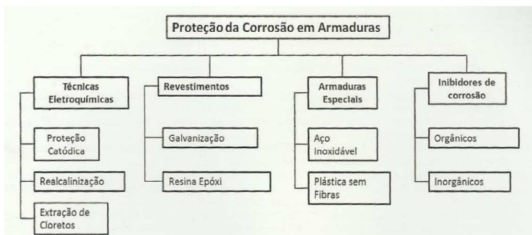
Figura 10- Métodos de proteção da corrosão em armaduras.
