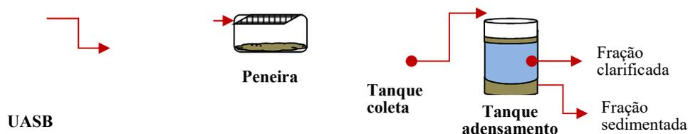
**Figura 4.13:** Representação da sequência de descarte, peneiramento e adensamento da espuma
