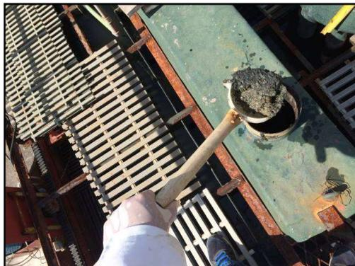
**Figura 4.8:** Coleta da espuma retida no STf por meio de peneira de amostragem de 1 mm.
