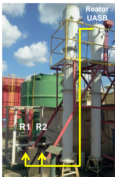
Figura 4-1: Foto do aparato experimental constituído pelo reator UASB em escala piloto e por dois reatores destinados a remoção biológica de sulfeto (R1 e R2) (GARCIA, 2014).
