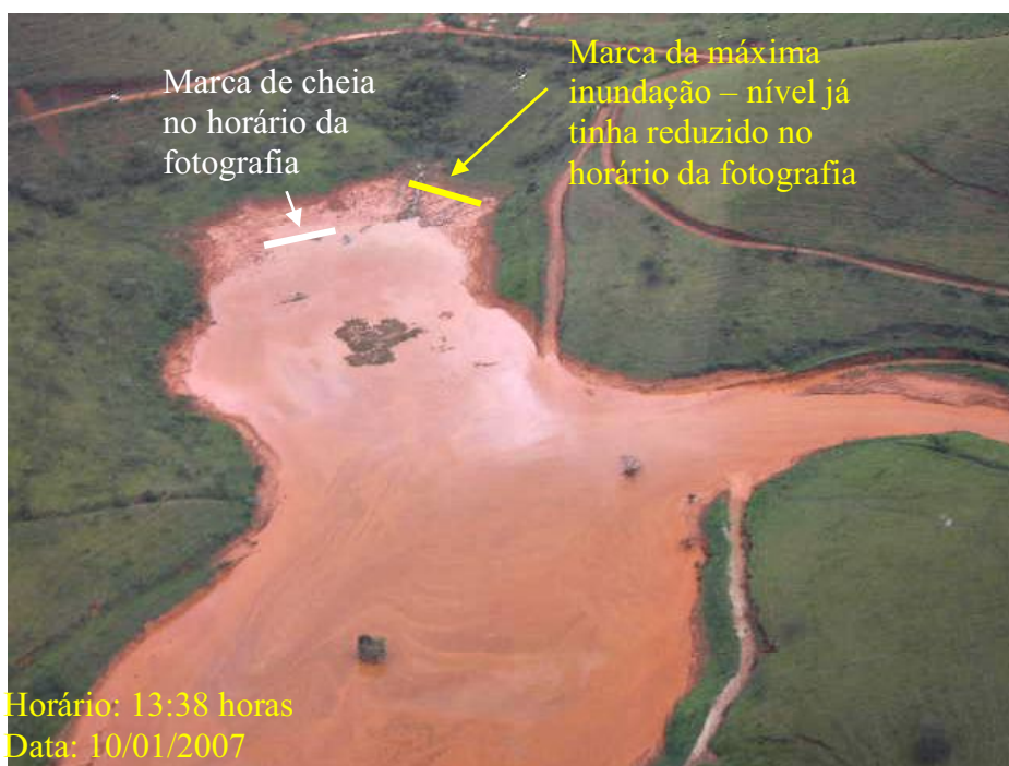
Figura 5.15 – Inundação de várzea localizada a cerca de 2 km a jusante da barragem – detalhe para a marca referente ao nível de água máximo Fonte: SAWAYA (2007).
