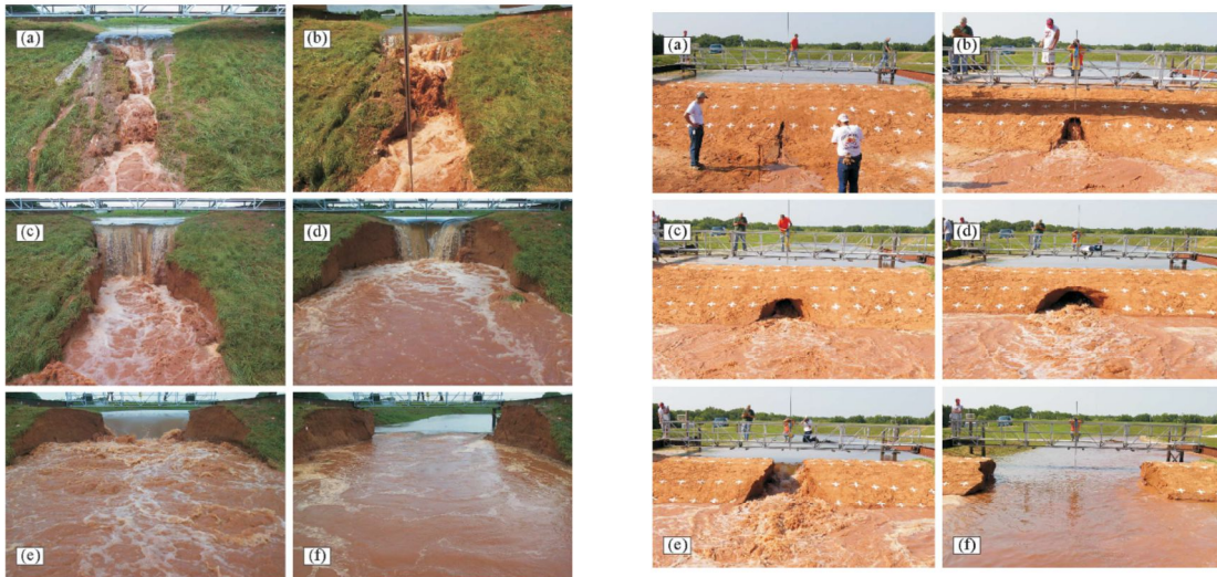
Figura 3.3 – Ensaio de campo realizado pelo NRCS (modo de falha galgamento e piping ) Fonte: ASCE/EWRI (2011).
