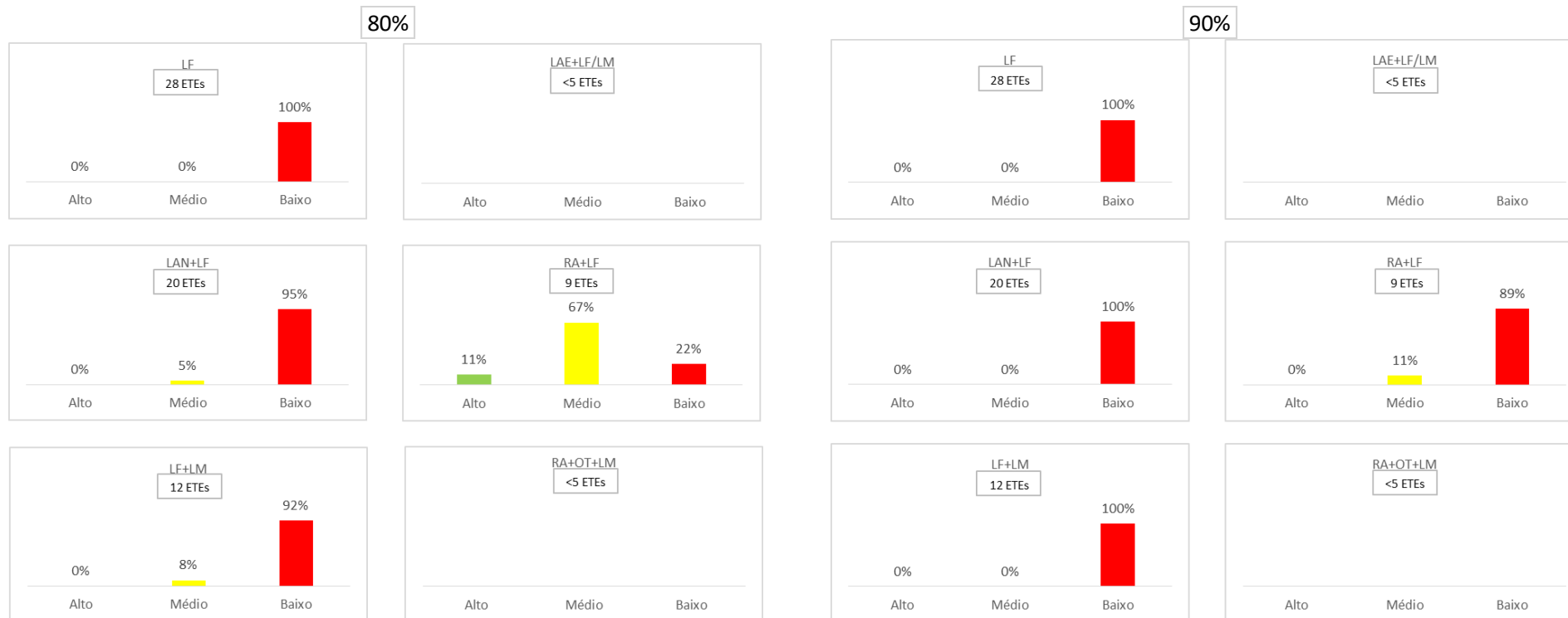
Figura 5.13b Percentual de atendimento das sete configurações à meta de eficiência de remoção de 80% e de 90% de SST, segundo os critérios Alto, Médio e Baixo.
