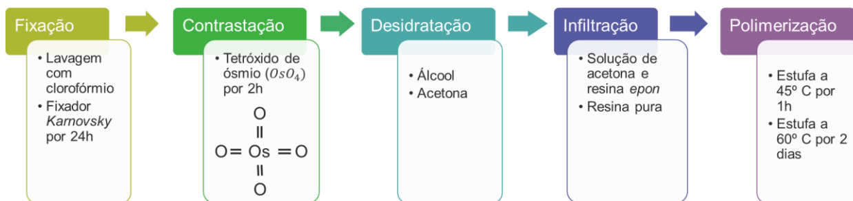
Figura 34 - Esquema mostrando a ordem do protocolo de procedimentos da preparação das amostras para TEM descrito nesta sessão.
