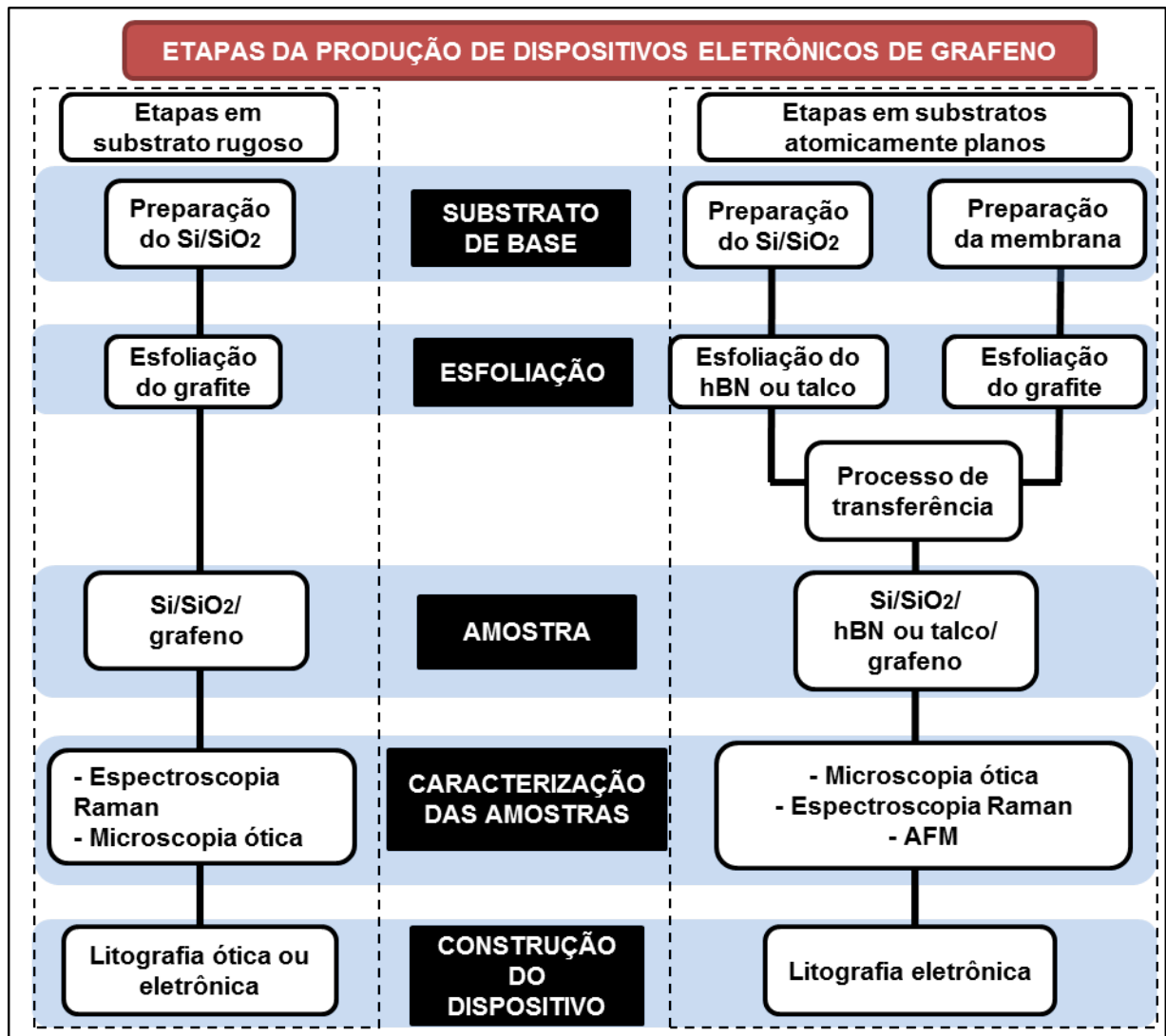
Figura 3.1: Esquema das principais etapas de produção de dispositivos eletrônicos de grafeno depositado sobre diversos substratos.
