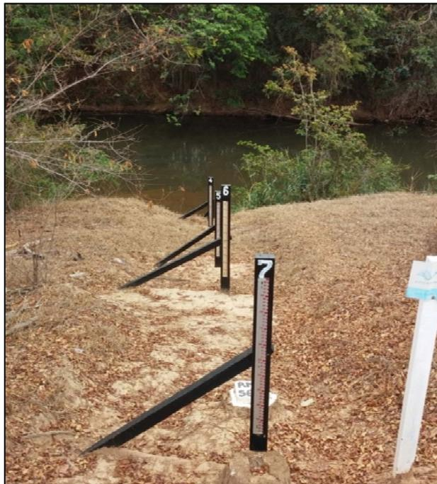
Figura 1.1 - Réguas limnimétricas da estação fluviométrica Curimataí
