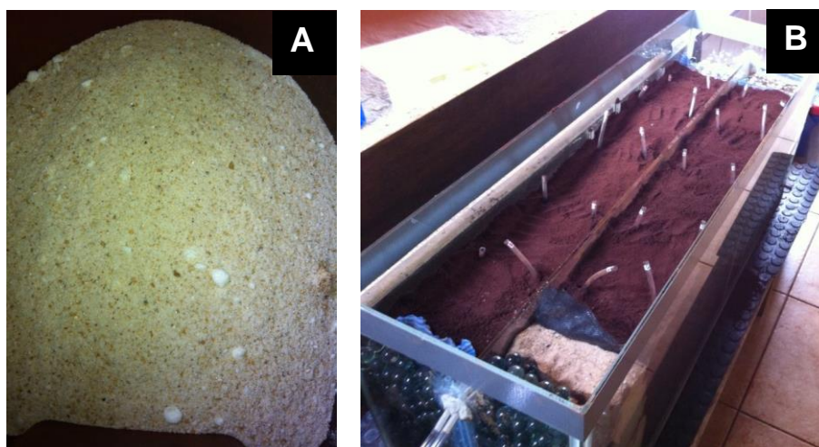
Figura 4.11 - Mistura de areia com persulfato de sódio que compunha o meio reativo (A), e reator de solo, com destaque para as sessões com oxidante e controle (B).
