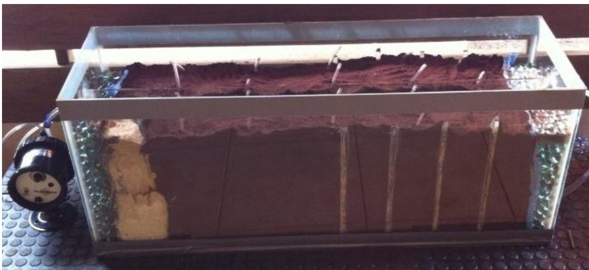
Figura 4.11 - Mistura de areia com persulfato de sódio que compunha o meio reativo (A), e reator de solo, com destaque para as sessões com oxidante e controle (B).
