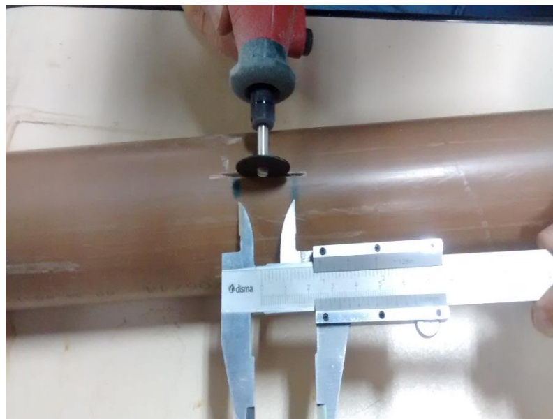
Figura 26 – Fissura Longitudinal – Detalhe da mini retífica
