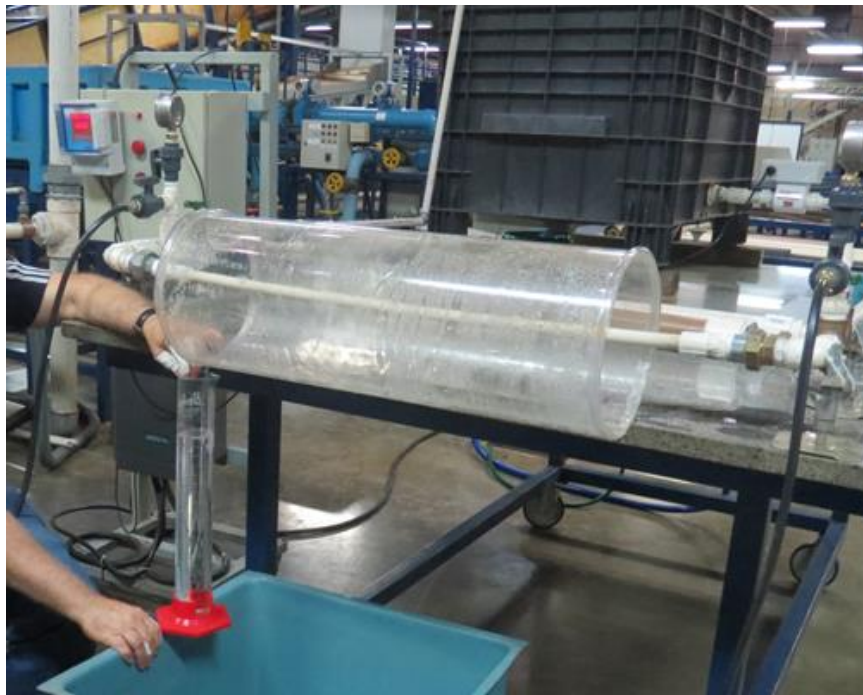
Figura 22– Medições de baixas vazões
