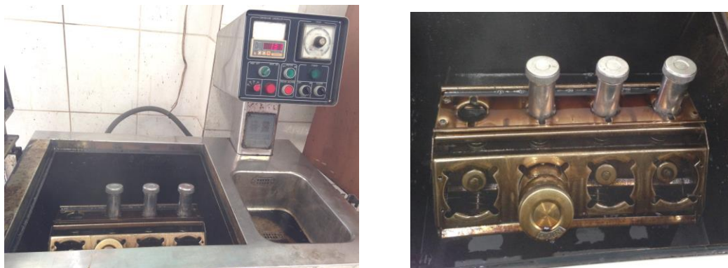
FIGURA 4.6 – Máquina piloto utilizada nos testes de tingimento.
