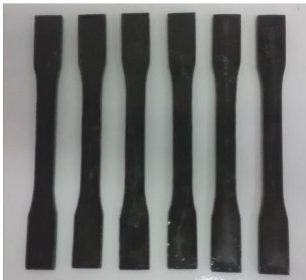
FIGURA 21 - Corpos de prova para ensaio *dog bone*.
