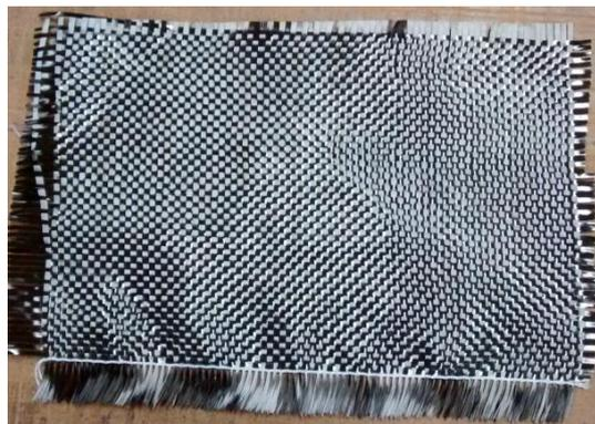
FIGURA 16 - Fibra de carbono entrelaçada utilizada na produção dos compósitos.
