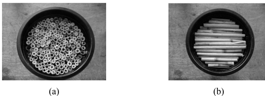
Figura 2.6: Configuração de colocação da amostra para ensaio: longitudinal (a) e transversal (b).
