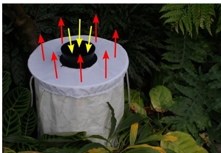
Fig. 31. Armadilha BG-Sentinel® (BGS). Setas vermelhas indicam o local de saída corrente de ar e setas amarelas indicam o local da entrada da corrente de ar, favorecendo a sucção de insetos.
